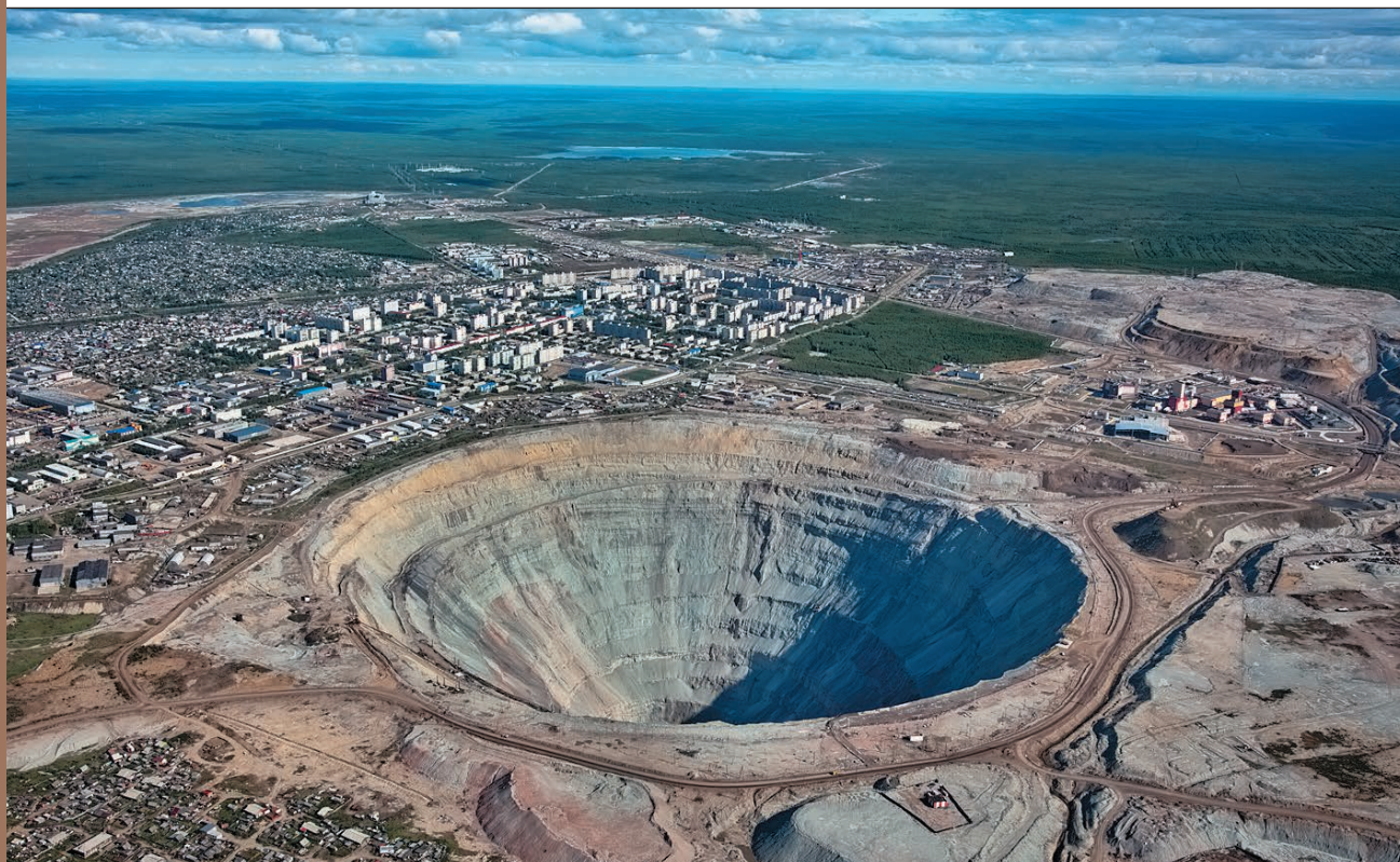
Рис.1. Аэрофотоснимок алмазоносного карьера кимберлитовой трубки «Мир» (Якутия). Диаметр воронки 1200 м, глубина 525 м.
